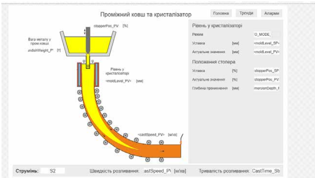
Рис. 10. Сторінка візуалізації стану проміжного ковша та кристалізатора з прив'язкою анімованих змінних
